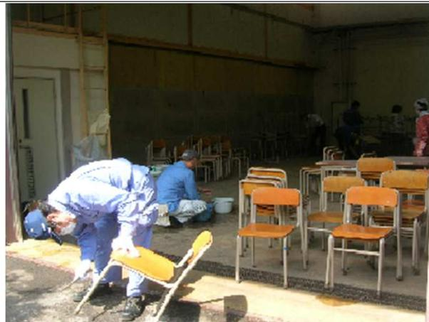
机・椅子補修②「錆落としのヤスリがけ」
